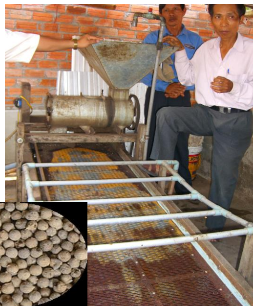
H68: Máy xát vỏ hạt tiêu sau khi ủ và tiêu trắng thành phẩm
